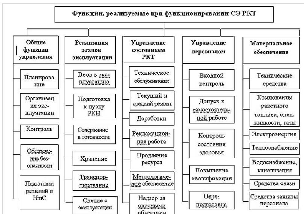
Рисунок 1 – Функциональная структура системы эксплуатации РКТ
