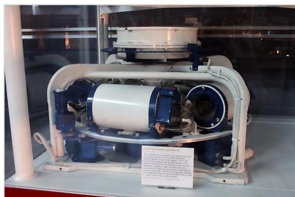
Рис. 10. «БИОС – Центрифуга» установленная на борту космического аппарата Бион-4, в которой десять крыс подвергали 1-G искусственной силы тяжести
