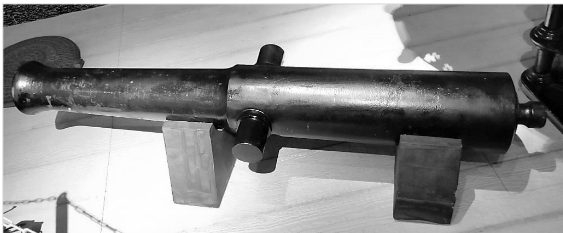
Рис. 2. Модель 4-фунтовой гладкоствольной стальной пушкой дульного заряжания в Музее истории Обуховского завода [3]
