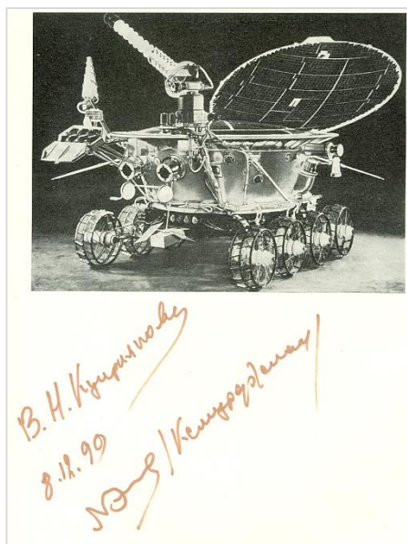
«Луноход-1» перед отправкой на Луну до «одевания» его в экранно-вакуумную теплоизоляцию. Внизу – автограф А. Л. Кемурджиана. Личный архив автора
