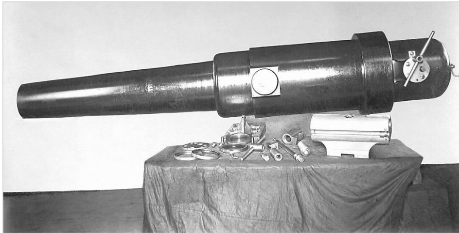
Рис. 3. 8-дюймовое стальное нарезное артиллерийское орудие казенного заряжания, изготовленное Обуховским заводом [1]
