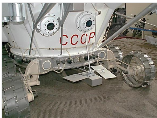
Луноход-1. По центру внизу видна аппаратура РИФМА (Рентгеновский Изотопный Флуоресцентный Метод Анализа), использованная для проведения химического анализа лунного грунта по трасседвижения аппарата. Санкт-Петербург, Музей транспортных средств. Фото В. Куприянова. 10.08.2010 г.
