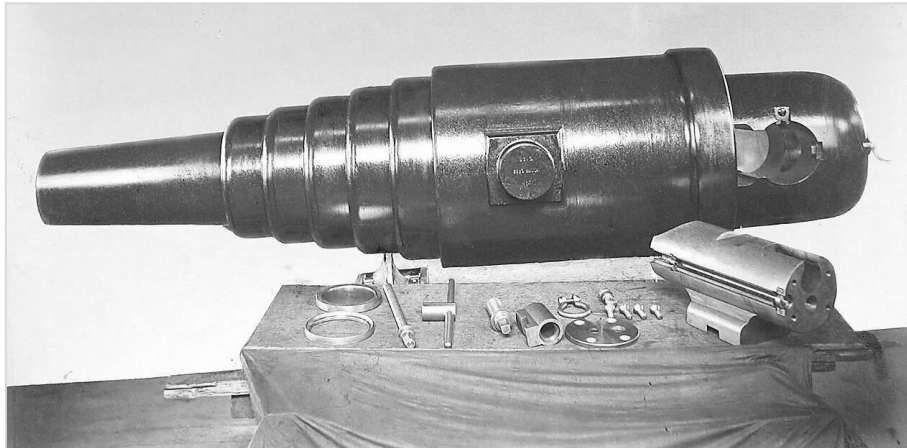
Рис. 4. 9-дюймовое стальное нарезное скрепленное кольцами артиллерийское орудие казенного заряжания, изготовленное Обуховским заводом [1]
