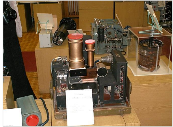
Аппаратура «Енисей». Бортовой комплекс. Обеспечил получение фотографий обратной стороны Луны. Разработка ВНИИ Телевидения Музей ФГУП «НИИ Телевидения». Фото В. Куприянова. 22.10. 2009 г.
