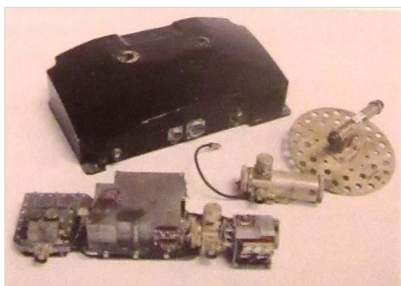
РДМВ – радиовысотомер малых высот для АМС «Марс-3». Разработан и изготовлен НИИ 137 (НИИ Точной механики) [5]
