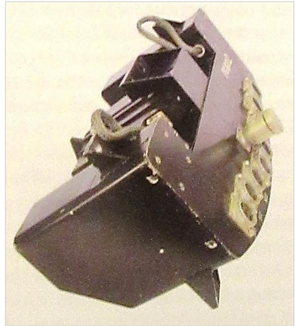
Система управления посадкой СУП-267 АМС «Марс-3». Разработана и изготовлена НИИ 137 (НИИ Точной механики) [28]
