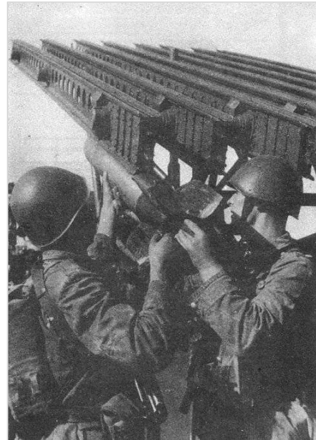
Рис. 7. Заряжание снаряда на пусковую установку
