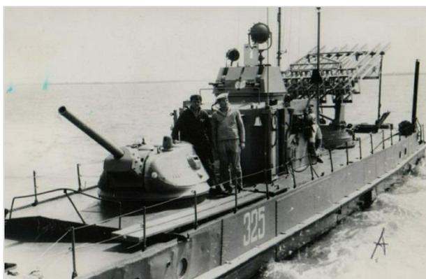
Рис. 11. Бронекатер пр. 1124 с орудийной башней и пусковой установкой реактивных снарядов (в корме)
