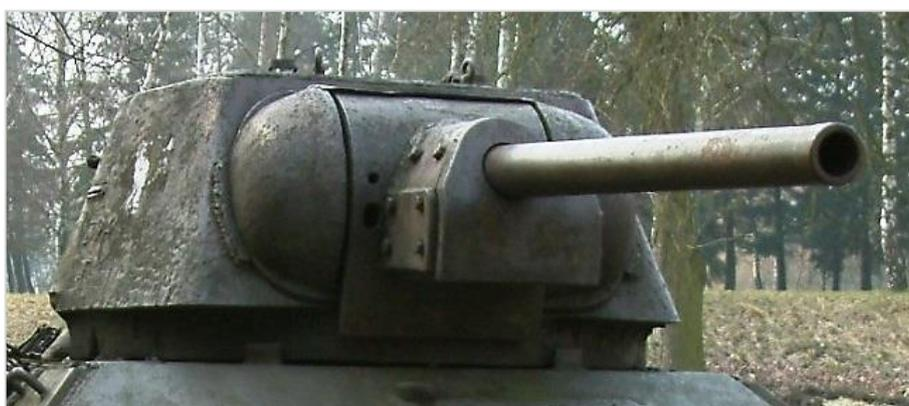
Рис. 7. 76-мм танковая пушка Ф-34
