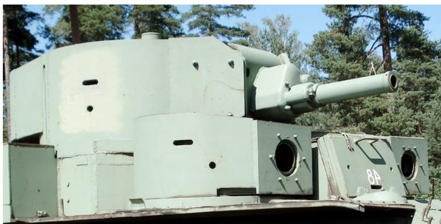
Рис. 5. 76-мм танковая пушка Л-10
