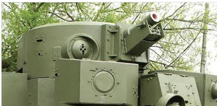
Рис. 4. 76-мм танковая пушка КТ-28
