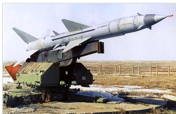
Рис. 6. Элементы ЗРС С-75: ЗУР В-750 на ПУ СМ-63 во Вьетнаме и на ПУ СМ-90 на полигоне [11]
