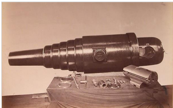
Рис. 10. 9/22-дм корабельная пушка образца 1867 года [7]
