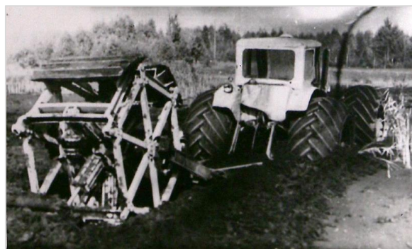
Рис. 2. Шагающее колесо в процессе испытания [1, с. 9]
