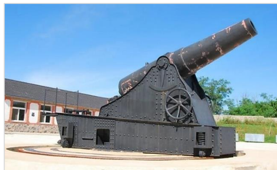
Рис. 7. 11/22-дм корабельная пушка образца 1877 года на станке системы Попова [17]
