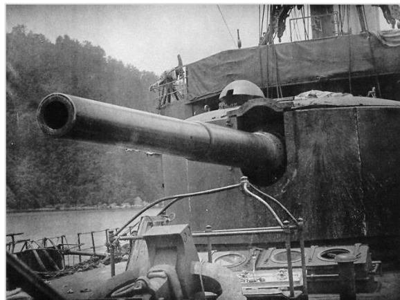
Рис. 8. 10/45-дюймовая одноорудийная башенная артиллерийская установка броненосца береговой обороны «Генерал-адмирал Апраксин» (1899 г.) [19]
