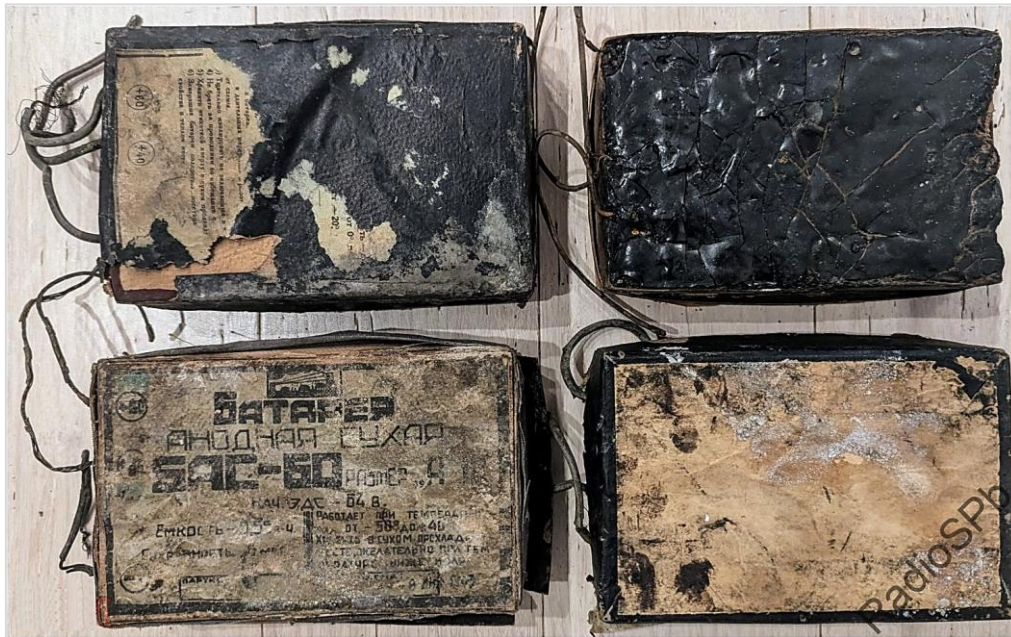
Рис. 7. Комплект батарей БАС-60 для питания радиостанции «Север», найденный под полом в квартире на канале Грибоедова (фото Ю. С. Азизяна)
