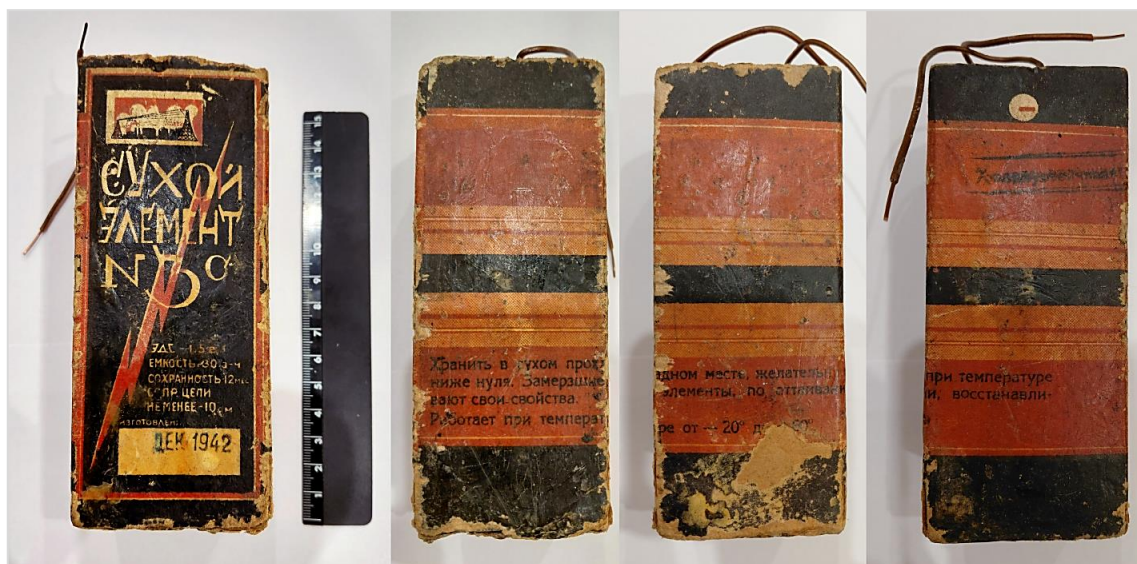
Рис. 9. Сухой элемент 3С, выпущенный в Ленинграде в декабре 1942 г. (фото авторов)
