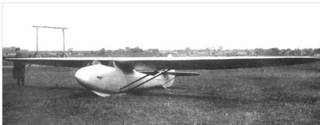
Рис. 4. Планер Г-9 конструкции В. К. Грибовского строился серийно. Размах крыла – 12.1 м, длина – 5.7 м, высота – 1.45 м, площадь крыла – 13 м 2 , максимальная взлетная масса – 230 кг, аэродинамическое качество – 17.5. На буксире, представлявшем собой стальную проволоку диаметром 0,2 мм длиной до 7000 м, поднимался за самолетом на высоту более 12 км. На Г-9 установили рекорд длительности полета – 35 ч 11 мин., на нем в течение 5 ч выполнили 300 петель Нестерова; летчик С. Н. Анохин [6] летал на буксире в перевернутом положении
