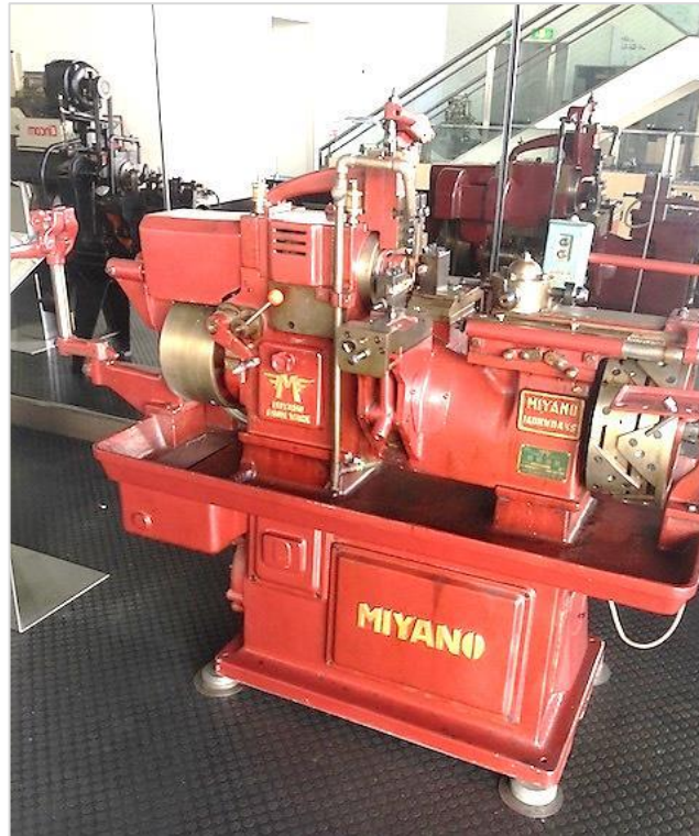
Рис. 5. Автомат продольного точения Miyano, представитель японской школы высокоточной обработки прутковых деталей
