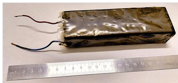
Рис. 2. Сухой элемент С-17 производства 1980-х гг. (фото авторов)
