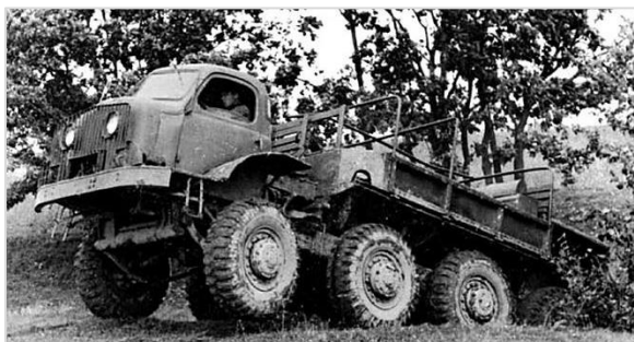
Рис. 2. Двухмоторный тягач ЭАТЭ-1 с электрической трансмиссией
