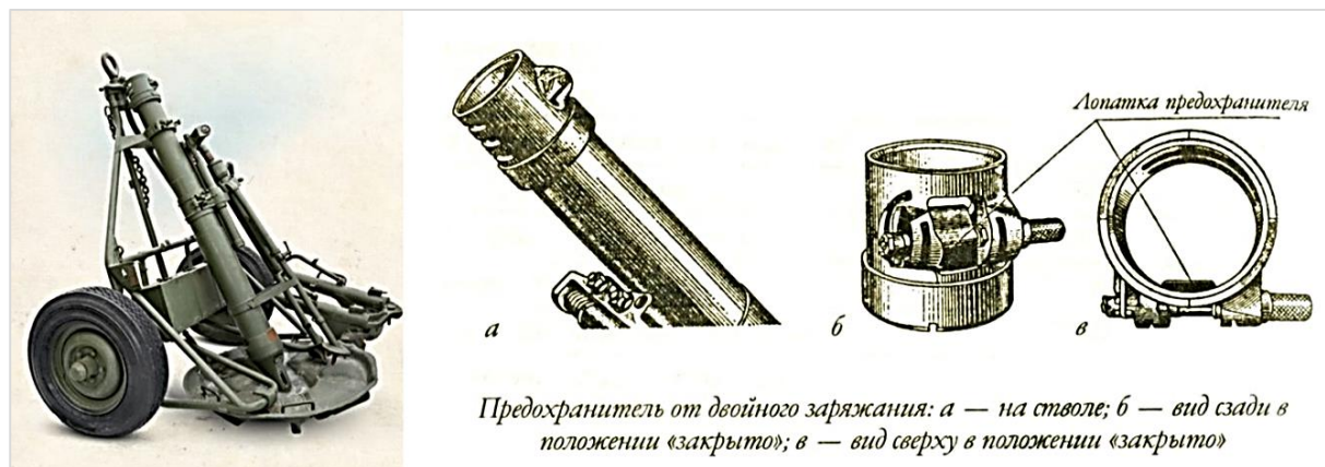
Рис. 7. 120-мм полковой миномет ПМ-38 образца 1943 года с предохранителем от двойного заряжания [3, 6]
