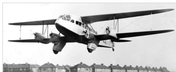
Рис. 12. Английский шестииместный пассажирский самолет de Havilland Dragon Rapide, выполненный по схеме биплан, имеющий довольно сложное шасси, одетое в фигурные обтекатели, затруднявшие их осмотр и обслуживание. Отличался плохой обзорностью для пассажиров из-за нижнего крыла и отличной – для пилотов. Был дорог и сложен в обслуживании.
