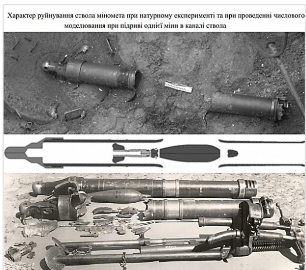
Рис. 13. Разрушения ствола М120-15, полученные в результате натурального эксперимента ВСУ за счет принудительной детонации одной мины (вверху) и последующего численного моделирования процесса (в центре). В нижней части снимка представлены результаты фотофиксации того же процесса, полученные Э.И. Борейшей на полигоне «Ржевка» в 1967 г. Верхнее фото из источника [1], нижнее из АНТД БГТУ «Военмех»
