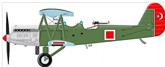
Рис. 5. Легкий бомбардировщик/разведчик Р-5 с опознавательными знаками и цветовым оформлением, присущим ВВС Турции в 1930-е гг (вид с правого борта, слева не было подножек для посадки экипажа в кабины). Под крылом видны бомбодержатели
