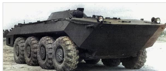
Рис. 5. «Объект 1200» с гидропневматической подвеской
