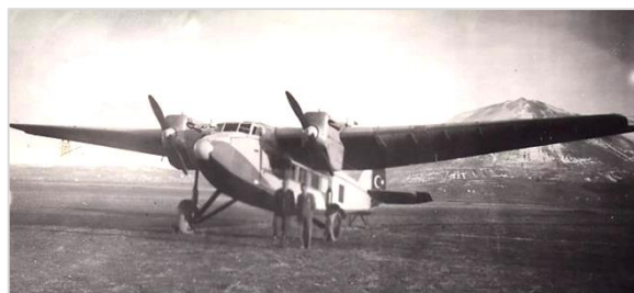
Рис. 6. Самолет ПС-9 турецких авиалиний с двумя двигателями М-17 на аэродроме Этимесгут, Анкара
